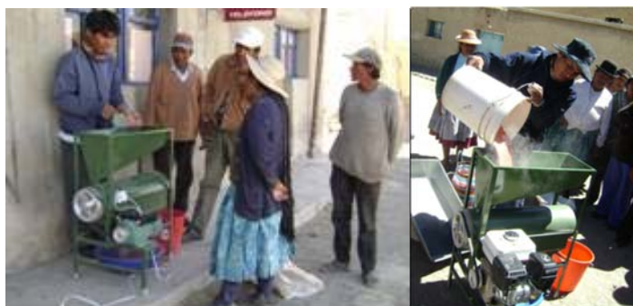
Foto 4. Prueba de funcionamiento de la 'microbeneficiadora' para quinua en la comunidad Jirira.
