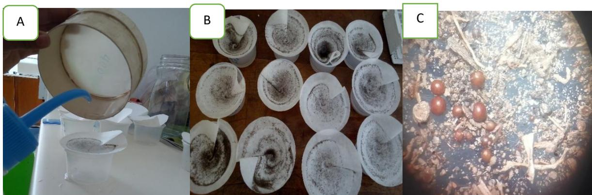
**Figura 9.** A) Lavado de la muestra B) Muestra lavada, puesta en papel filtro C) Conteo de quistes en estereoscopio.
